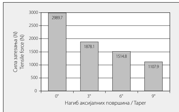
ГРАФИКОН 3. Силе затезања измерене на експерименталним патрљцима различитог нагиба аксијалних површина.
