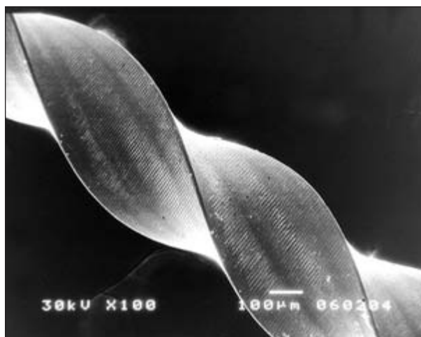
Слика 4б. SEM приказ истог инструмента после ултразвучног чишћења (оцена 0)
